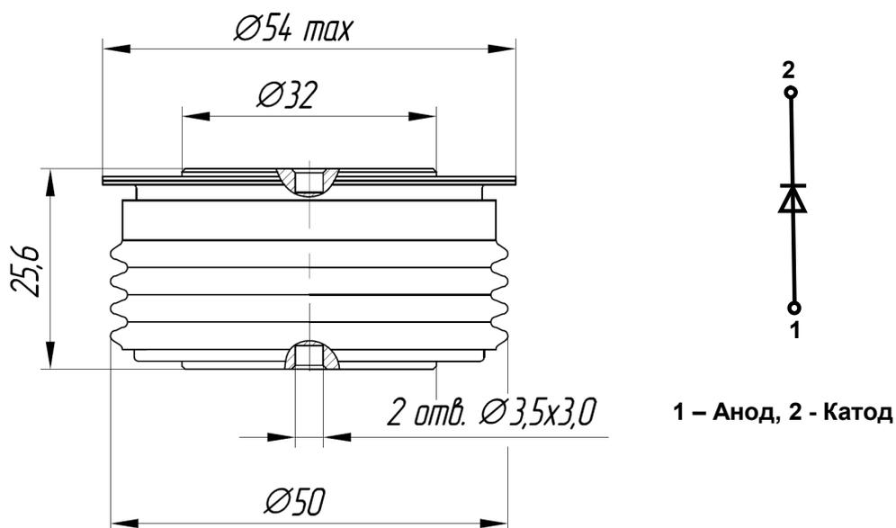
Рис. 1. Габаритные и установочные размеры
