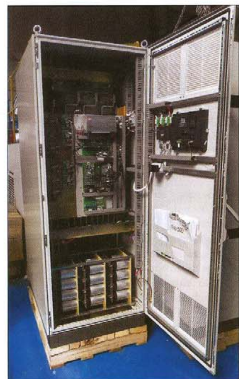
Рис. 12. Статический преобразователь в конструктиве «Риттал»
